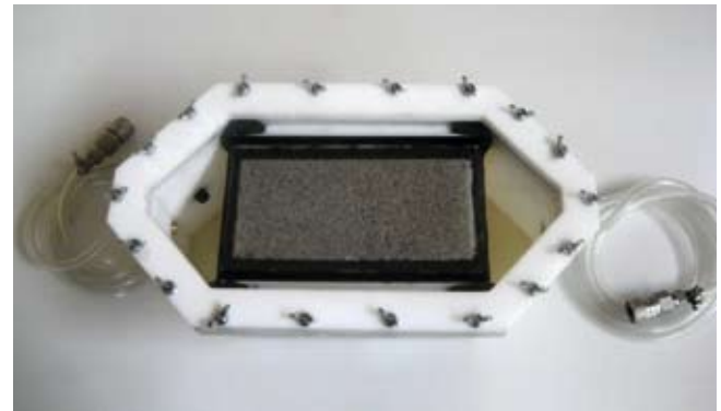
5 Reactor cell with embedded paving block Reaktorzelle mit eingebautem Pflasterstein
